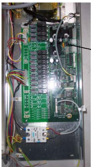
Жгут проводов считывающего устройства к контрольной карте соединителя
